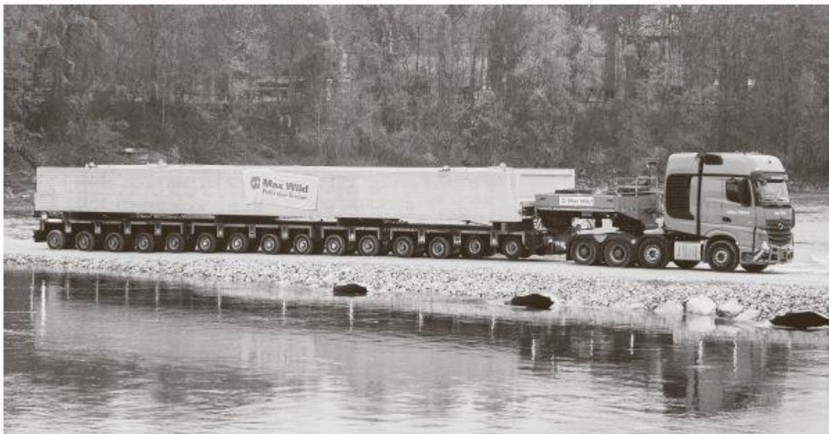
Das größte Segment für den Fußgängersteg wiegt 105 t und ist 22 m lang.
